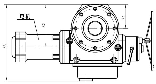
SMC-3、4法兰连接形式尺寸
